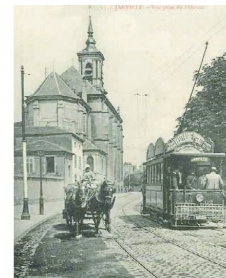
Notez : la partie blanche sur les poteaux qui indique le lieu d'un arrêt du tramway et à l'arrière (comme à l'avant) du tram le filet de "protection" ancêtre des pare-chocs et les "réclames" car on ne parle pas encore publicité sur la motrice.
